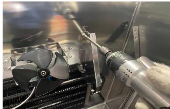
D. Remove the air guide (L/R)
