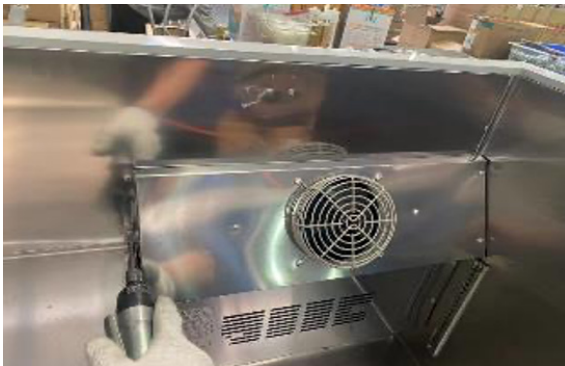
C. Remove the evaporator fan motor
